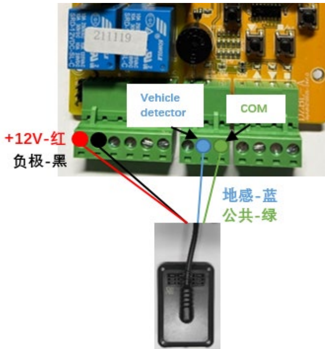
图4-5 防砸雷达电源、信号接线
